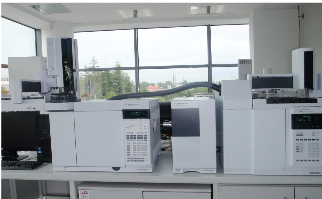
Fotografia 14. Chromatograf gazowy ze spektrometrem mas (GC-MS - pułapka jonowa) 7890A/2201on Trap/HSP 7697A firmy Agilent Technologies - do oznaczeń substancji organicznych
