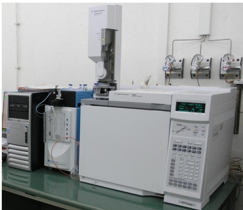
Fotografia 12. Chromatograf gazowy 6890N firmy Agilent Technologies z detektorem płomieniowo-jonizacyjnym (FID), detektorem wychwytu elektron (ECD) i przystawką PT (Purge and Trap), do oznaczeń substancji organicznych
