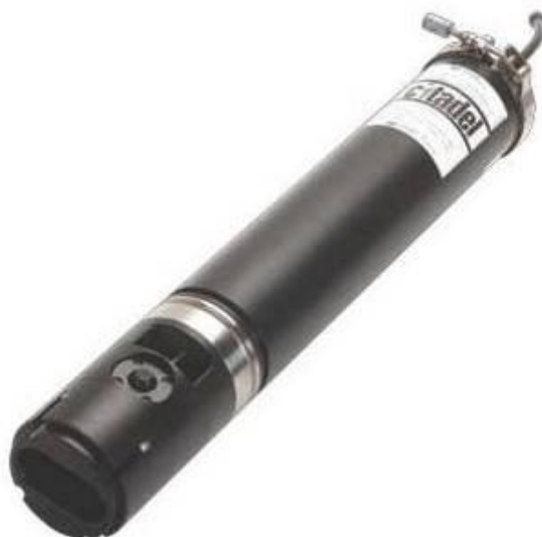
Fotografia 7. Sonda oceanograficzna CTD
