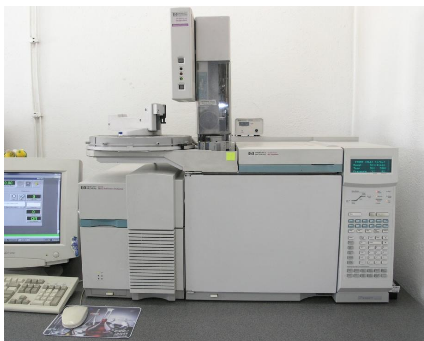
Fotografia 13. Chromatograf gazowy ze spektrometrem mas (GC-MS) firmy Agilent Technologies do oznaczeń substancji organicznych
